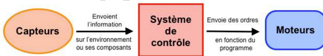
Figure 2 : schéma simplifié du fonctionnement d'un robot
